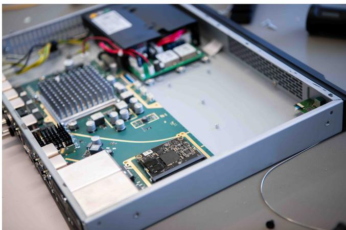
L'intégration de Spectera dans les workflows de production broadcast sera facilitée par un module Merging ZMAN (situé sur le côté droit du plus grand circuit imprimé). Celui-ci permettra à la station de base de fonctionner selon la norme ST 2110-30
